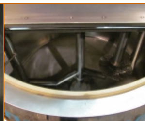
котел варочный с двумя мешалками
